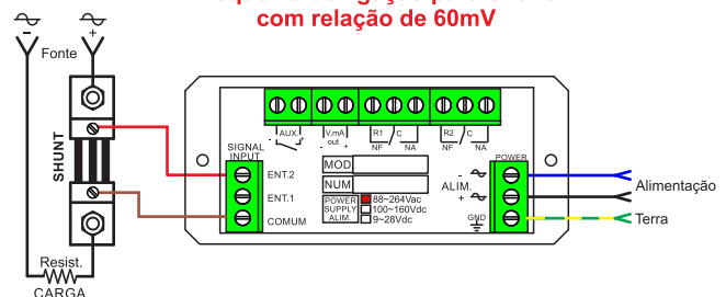
Esquema de ligação para Shunt com relação de 60mV
