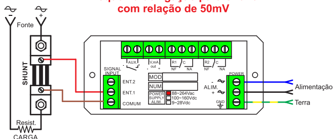
Esquema de ligação para Shunt com relação de 50mV
